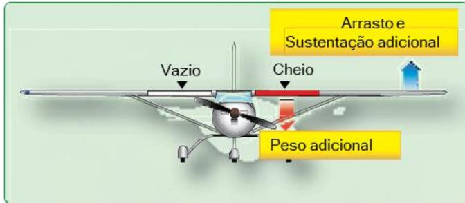
**Figura 1-4.** O desbalanceamento lateral causa o peso das asas, que pode ser corrigido desviando o aileron. A sustentação adicional causa arrasto adicional, e o avião voa ineficientemente
