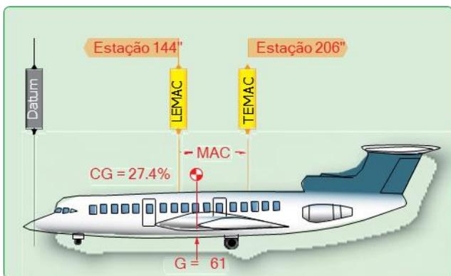
**Figura 3-17.** Aeronave pesada e o diagrama de cálculo de balanceamento.
