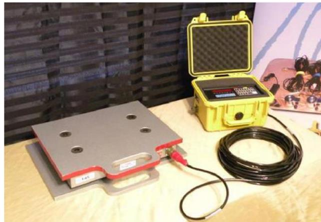
Figura 3-1. Balanças de plataforma.
