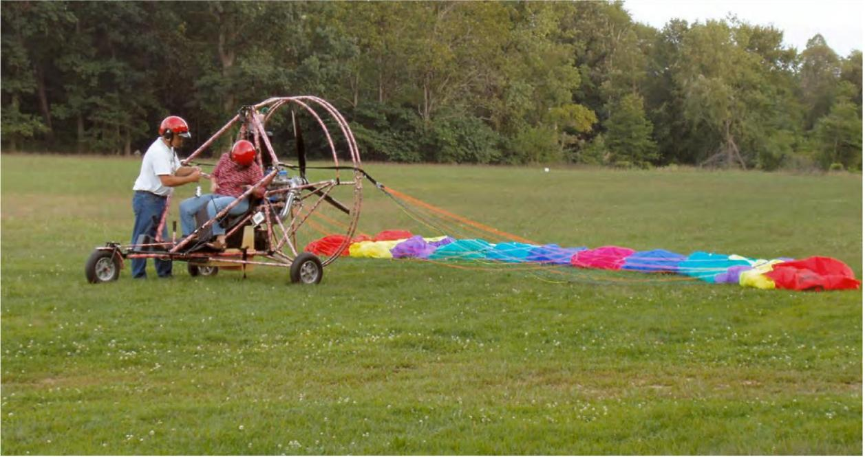
**Figura 4-8.** *Paraquedas motorizado.*
