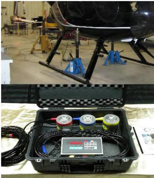
Figura 3-3. Balança de células de carga.
