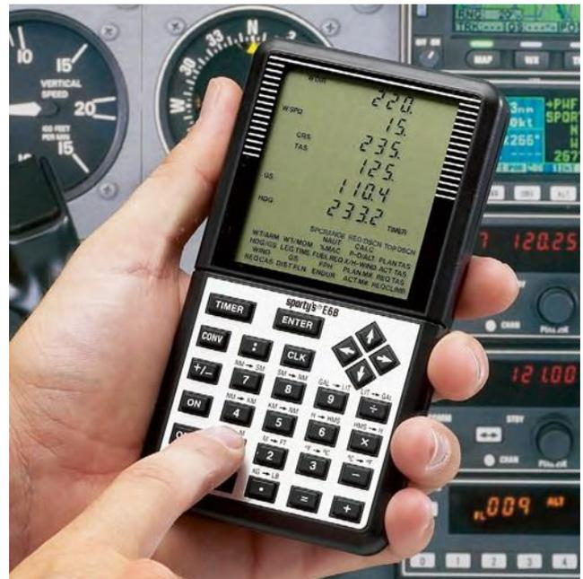
Figura 10-5. Computadores eletrônicos dedicados são programados para resolver problemas de peso e balanceamento, bem como problemas de voo.
