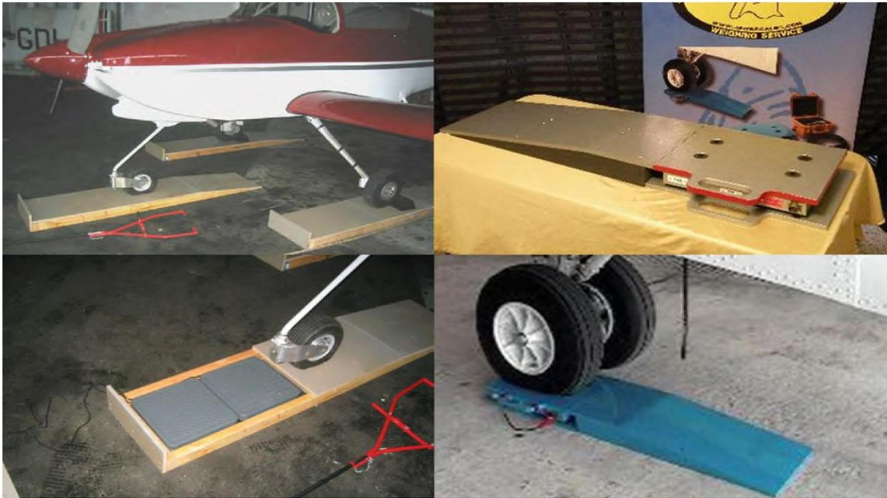
Figura 3-2. Balança de rampa.
