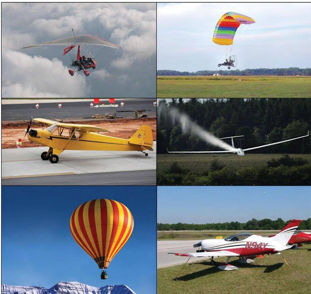
**Figura 4-1.** Exemplos de aeronaves esportivas leves (do canto superior esquerdo, no sentido horário): controle de mudança de peso, paraquedas motorizado, aviões, planador, balão de ar quente e LSA amadora.
