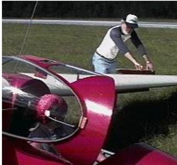
No processo de montagem, não só as asas e as superfícies horizontais da cauda (e quaisquer outras partes que foram anexadas) precisam ser adequadamente anexadas ao planador, mas as superfícies de controle de voo nesses componentes (os ailerons, flaps e freios aerodinâmicos nas asas, o profundor nas superfícies horizontais da cauda) precisam estar devidamente conectados aos controles da nacele. Pilotos foram feridos e mortos como resultado da falha em conectar adequadamente os controles de voo.
