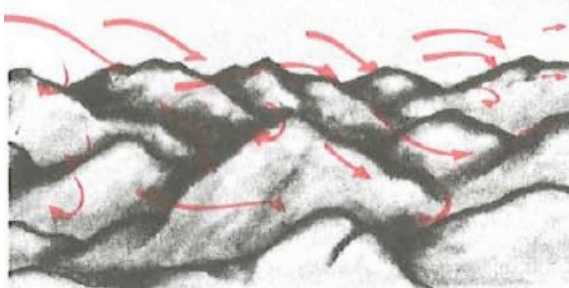
FIGURA 24. Fluxo de vento sobre vários tipos de terreno. Os muitos desvios desses padrões dependem da velocidade do vento, do perfil da inclinação e da rugosidade do terreno
