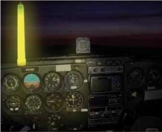
Figura 3-8. Uma vareta química é útil para carregar a bordo da aeronave à noite. Ela vem em várias cores, intensidades e durações, e fornece ampla iluminação dentro da cabine de voo. Isso não substitui a exigência regulatória de carregar lanternas.
