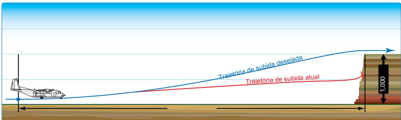
Figura 1-2. A figura acima é um desenho em escala de uma aeronave subindo a 1.000 fpm, localizada a 1 NM do final do cânion e partindo do piso do cânion 1.000 pés abaixo da borda. O tempo para cobrir 6.000 pés é de 24 segundos. Com a aeronave subindo a 1.000 fps, em aproximadamente 'Um minuto, a aeronave subirá apenas 500 pés e não ultrapassará a borda.
